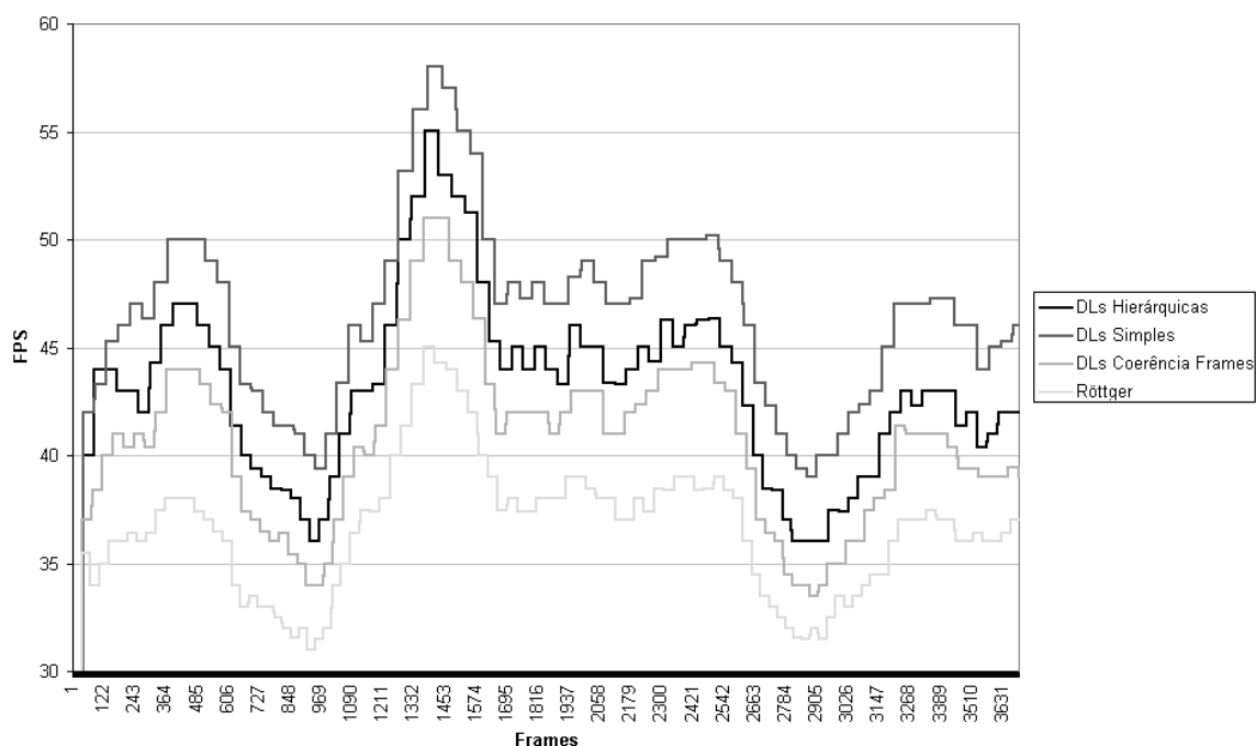
Figura 6-12: Taxa de FPS no terreno A de 1025x1025 num ciclo do percurso circular, velocidade rápida, realizado na máquina Calvin.
